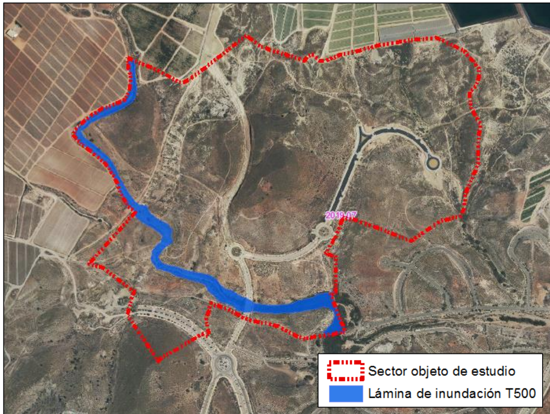
Figura 12. Lámina de inundación de la rambla del Jatico para un periodo de retorno de 500 años.
