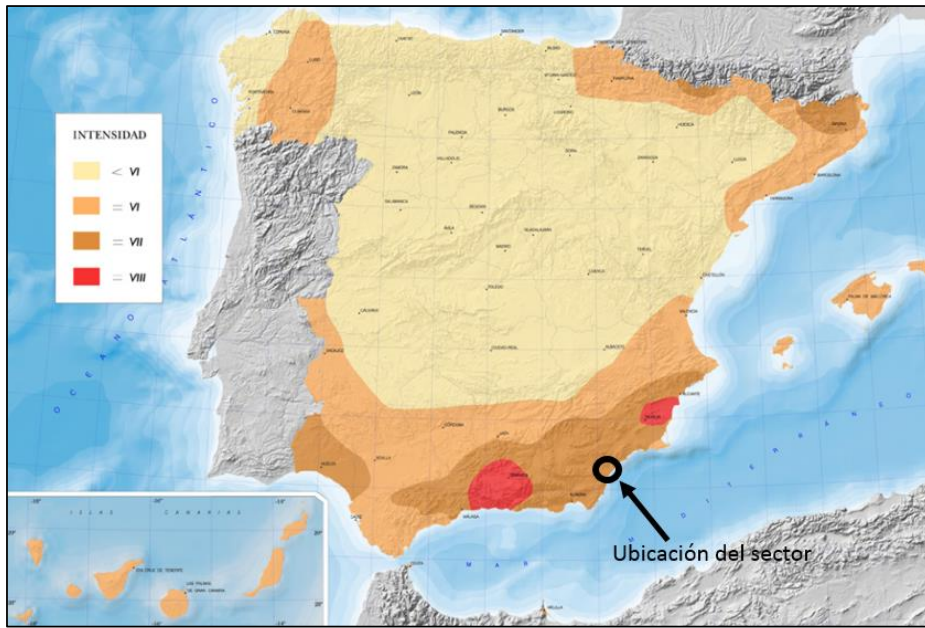
Figura 6. Mapa de peligrosidad sísmica de España para un periodo de retorno de 500 años. Fuente: Instituto Geográfico Nacional (IGN)
